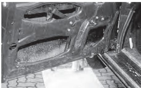
Das Endschutzmittel, also Wachs, z.B. HT, sollte an den Hohlraumenden nicht mehr so dick hervorquellen, da sonst bei der späteren Lackierung Haftungsprobleme entstehen. Falls also die kleinen Hohlräume der Motor- und Kofferraumhaube wie auch der Türen herausquellendes Wachs zeigen, muss dieses mit Verdünnung abgewaschen werden.
