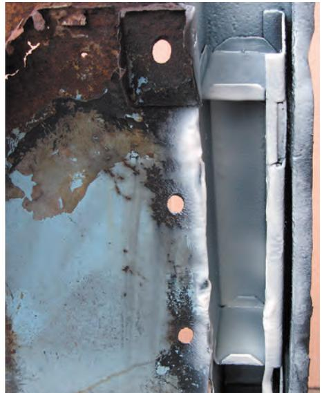
Dabei wird beim neu eingebrachten Wachs, durch die enthaltenen Lösungsmittel, die alte und bisherige Schicht leicht angelöst und die neue dünne Schicht fest verankert. Der empfohlene Druck bei der Verarbeitung des Hohlraum Schutzwachses ist für eine Saugbecher Pistole ca. 7,5 – 9,5 bar, bei Verwendung einer Druckbecher Pistole ca. 3,5 – 4,5 bar.
