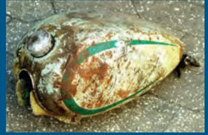
TAPOX findet Anwendung zur Innen-Beschichtung von Tanks wie Kraftstofftanks aus Stahl und Aluminium, Erdöl- bzw. Heizöl- Tanks, Ballast-Tanks von Schiffen, Wasser-Tanks (nicht für Trinkwasser) usw.
