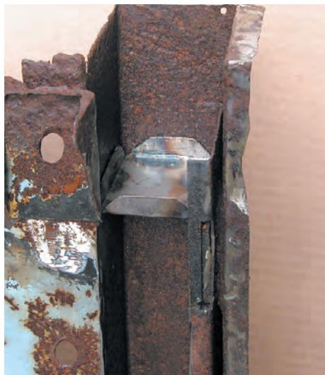
Ist die Stabilität der Karosse vorhanden, so ist eine Rostbeseitigung und Ablösung der Schadstoffe mittels FERTAN, zur Vorbereitung des später folgenden Endschutzes, vorzunehmen.
