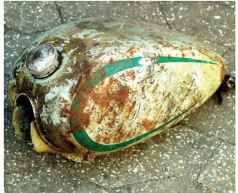
Den Tank jetzt mit der größten Öffnung nach unten für ca. 15 Minuten antrocknen lassen. Nach dieser Antrocknungsphase über die Ablauföffnung (Benzinhahn) einen konstanten Luftstrom ca. 0,2 bis max. 0,4 bar für mindestens 240 Minuten in den Tank leiten, da dadurch die ausdünstenden Rückstände des Lösungsmittels aus der nach unten gelagerten größten Öffnung entweichen können.
