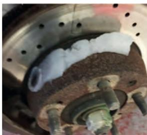
1. FERTAN Rost-Entfernungs-Gel aufgetragen. Absolut keine weitere Vorbehandlung erforderlich. Gleicher Auftrag auch auf den Bremssattel. Reaktionszeit 3 Stunden.
